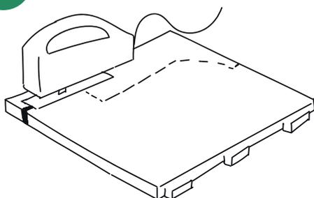
Keď sa dostanete k stenám alebo k prekážkam, pravdepodobne budete potrebovať dlaždice skrátiť, aby ste ich zarovnali so stenou. Odmerajte vzdialenosť medzi poslednou dlaždicou a stenou a odrežte prebytočnú časť dlaždice (napr. pomocou odlamovacieho noža).
