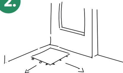
S pokladaním začnite v rohu. Položte prvú dlaždicu a uistite sa, že „hladké“ okraje sú obrátené doľava a hore (proti smeru pokladania) a jazýčky smerujú doprava a dole po smere pokladania, aby bolo možné na nich pripojiť ďalšie dlaždice.
